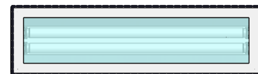
APLICAÇÃO DO SILICONE PELO PERÍMETRO DA MOLDURA
