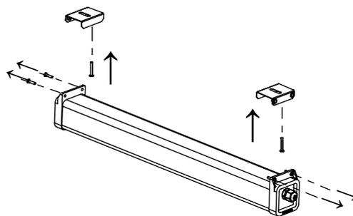
**2A- Aproxime a luminária do perfilado, passe os parafusos do suporte através do furo do perfil metálico e os trave com porcas.**
