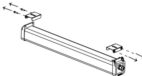
**2B- Coloque o grampo por cima do perfilado e o parafuse na tampa da luminária.**
