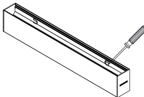
4- Faça a ligação conforme o passo 5 e então coloque o chassi no corpo dobrando as unhas para travar e então fixe o difusor:
