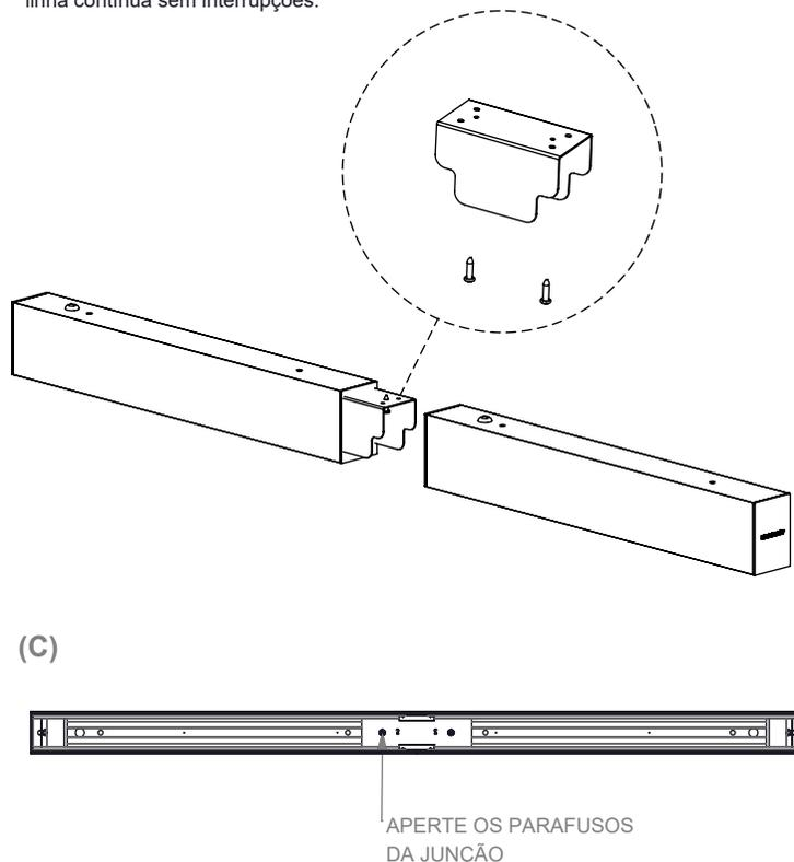
2- Após a instalação em linha dos Corpos das luminárias, prenda os Chassis pelo cabo de segurança ao Corpo, e proceda com a ligação elétrica entre um Chassi e outro. Estenda a ligação do conector de alimentação do Chassi (D) para o conector de alimentação do Chassi (E) conectando TERRA, FASE e NEUTRO. Faça o mesmo quando houver dimerização, ligando o ponto de [L]DIM+ e [N]DIM-. Esta extensão pode ser reproduzida para até 25 metros lineares de luminárias WAY.
