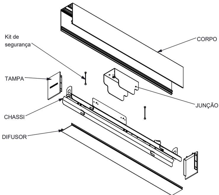
1- Com auxílio de uma chave de fenda, retire o difusor encaixando-a no espaço entre o Difusor e o Corpo da luminária, e empurrando o Difusor para fora.
