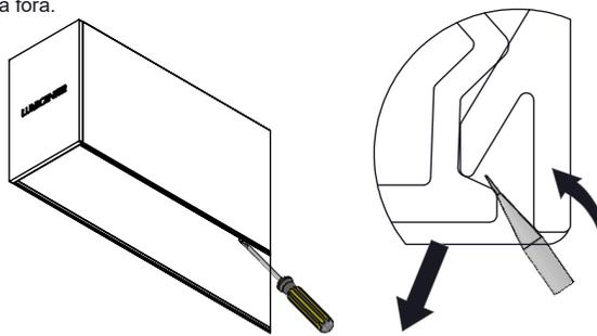
2- Retire o Chassi utilizando a chave de fenda, posicionando-a nos furos das orelhas, trazendo as orelhas para a sua posição original e puxando o chassi para fora do perfil.
