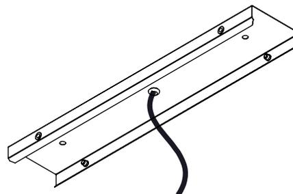
2 - Realiza as conexões elétricas ao **Conector de engate rápido**.
