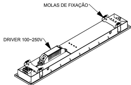
**1. RECORTE O NICHOS CONFORME MEDIDAS ESPECIFICADAS NA TABELA, EM SEGUIDA COM O DISJUNTOR DESLIGADO, FAÇA A CONEXÃO ELÉTRICA DA LUMINÁRIA.**
