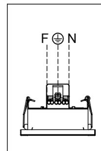
**2. PARA FINALIZAR A INSTALAÇÃO ROTACIONE AS MOLAS DE FIXAÇÃO E POSICIONE A LUMINÁRIA NO NICHOS.**
