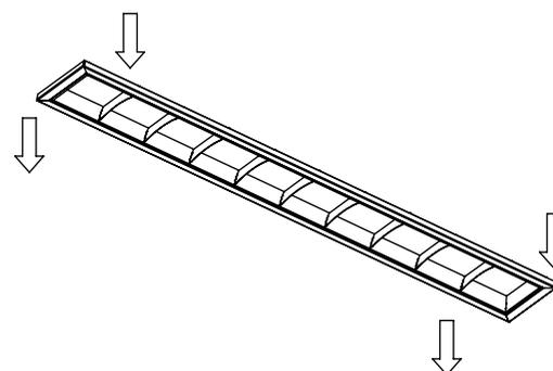
**\*\*EM INSTALAÇÕES EM FORROS MODULARES, APOIAR A LUMINÁRIA DIRETAMENTE SOBRE O PERFIL DO TIPO "T" INVERTIDO.**
