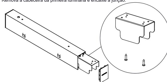
8- Certificando que a junção esteja centralizada, encaixe a próxima luminária da linha e aperte os parafusos da junção para alinhamento e fixação do conjunto, e faça as conexões elétricas.
