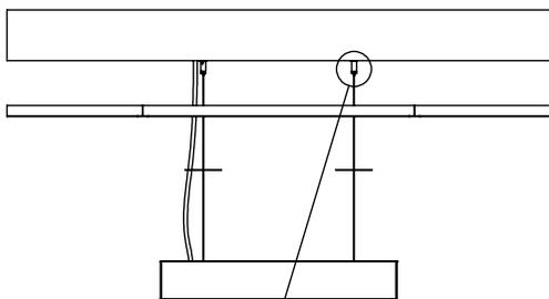
Pressione o pino e mova o cabo de aço para ajustar
