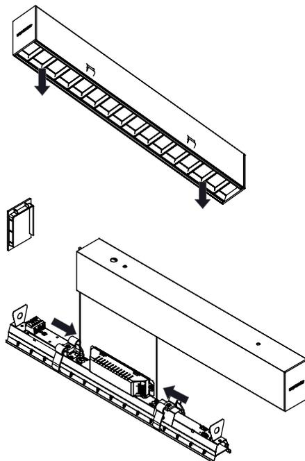
7- Utilize a junção para conexão mecânica entre as luminárias da linha. Remova a cabeceira da primeira luminária e encaixe a junção.
