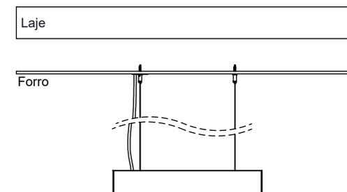
3- Nivelar as luminárias instaladas ajustando o cabo de suspensão.
