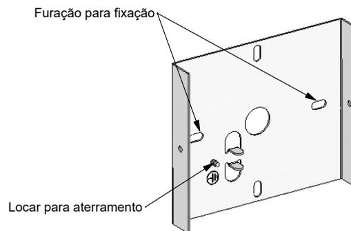
1 - Fixe a base à superfície de montagem utilizando sempre dois parafusos e buchas n°6.
