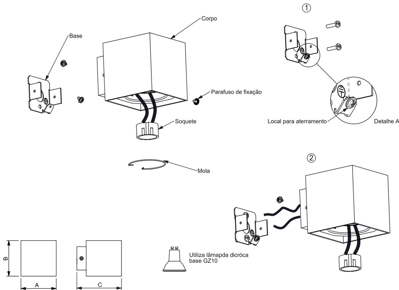
1 Fixe a base à superfície de montagem. Utilize dois parafusos e buchas n°6. Faça a conexão do cabo terra.
