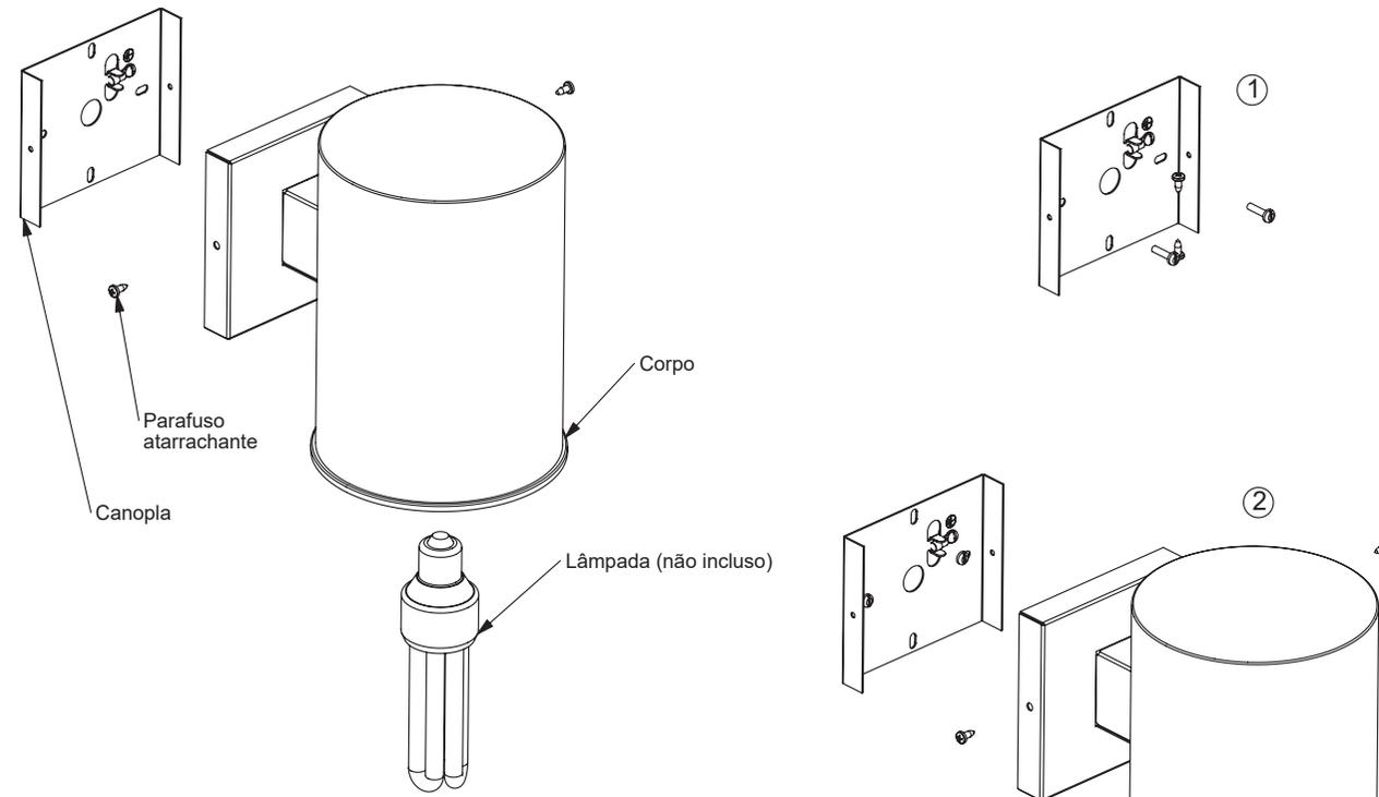
1 Fixe a canopla à superfície de montagem utilizando sempre dois parafusos. Quando necessário utilizar parafusos e buchas nº6.
